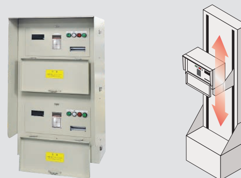
計量時に進入口に設置したセンサーによりトラックの車高を自動検知し、操作ポストが上・中・下3段階に自動昇降して計量します。
